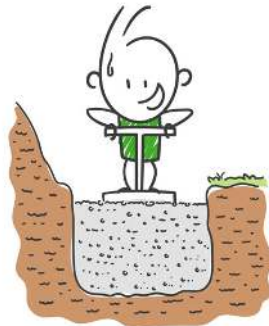
Schotter einbringen und verdichten
